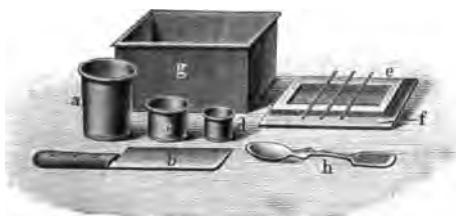
Fig. 46. — Appareils de Ritter pour l'essai rapide des ciments.
